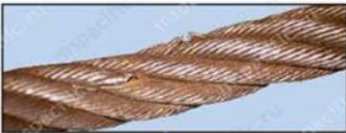
Местное уменьшение диаметра каната
